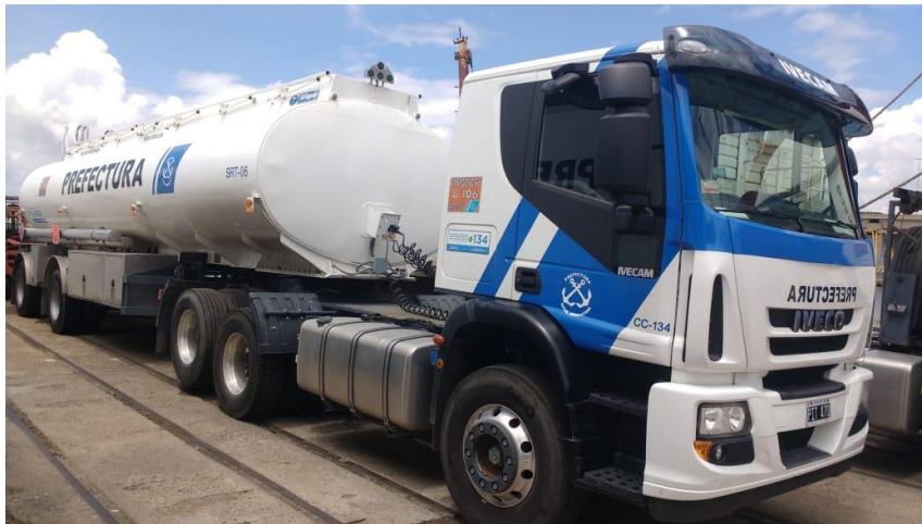
FIG 1: CAMIÓN DE CARGA TRACCIÓN SIMPLE (SIGLA CC-134 - IVECO CURSOR) – TRANSPORTE DE CARGAS INFLAMABLES - COMBUSTIBLES
