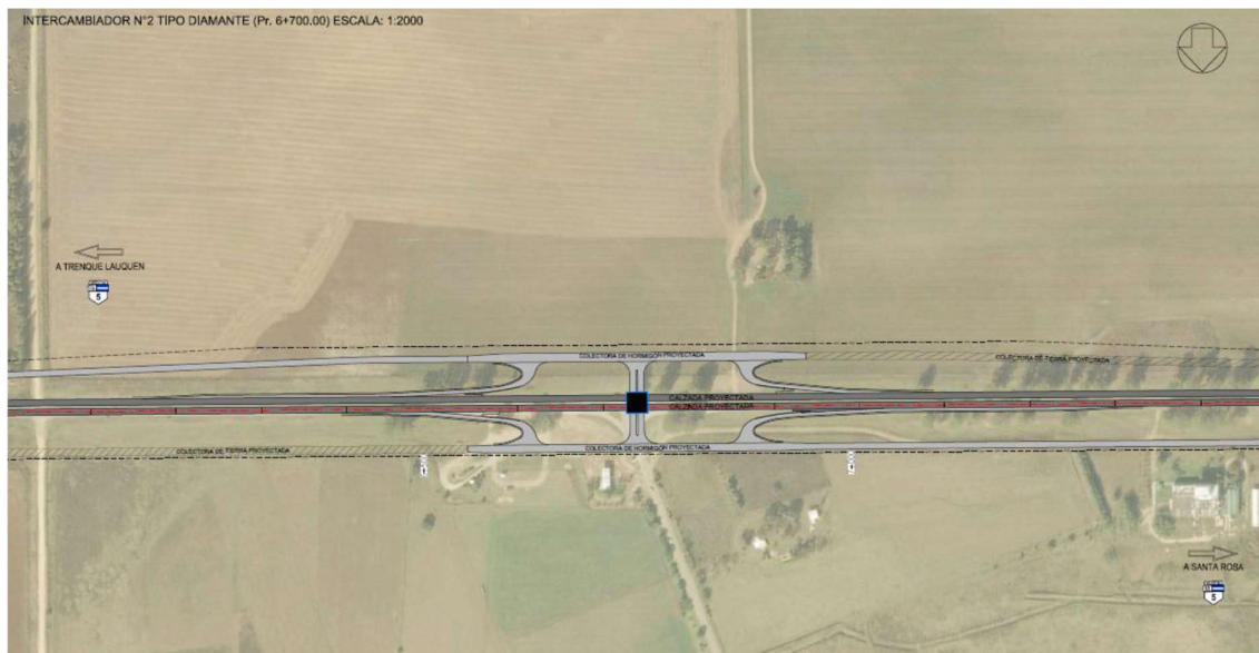
Figura N° 4: Intercambiador tipo diamante en Acceso a Anguil
