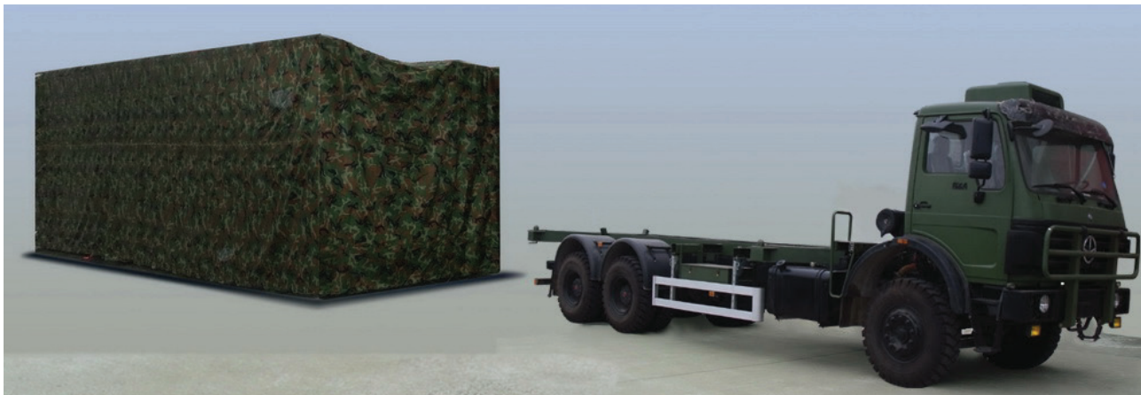
Figura 20. Separación de las barricadas del automóvil durante el almacenamiento a largo plazo.
