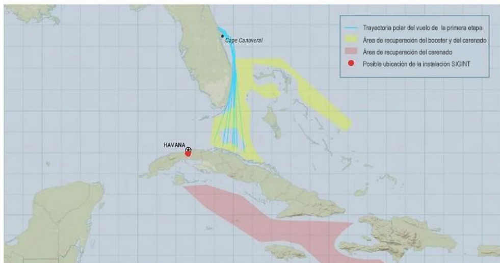
Figura 3: Propuesta de áreas de recuperación del propulsor de primera etapa y del carenado para una trayectoria de lanzamiento en el hemisferio sur del SpaceX Falcon
