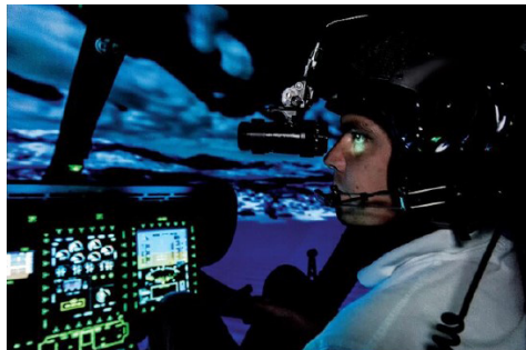
Entorno de adiestramiento completamente inmersivo: el Simulador de Vuelo Completo (por sus siglas en inglés, FFS) de Nivel D le brinda a la tripulación una experiencia de realidad virtual integrada con lentes de visión nocturna
