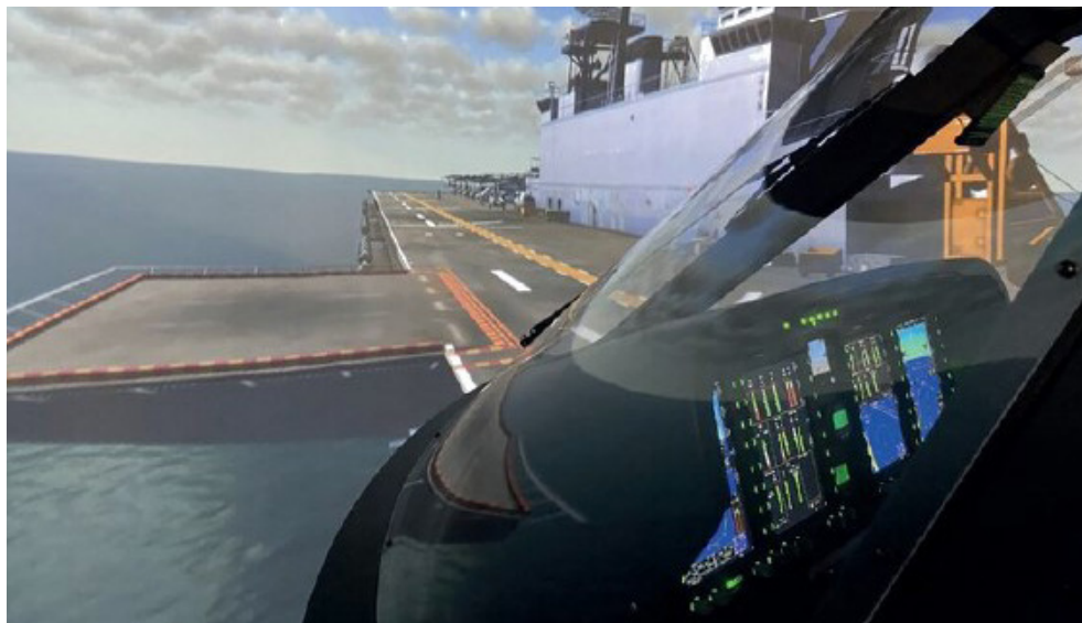
Uso de la tecnología holográfica para crear una imagen que simula el aterrizaje de un helicóptero en el puente de un portahelicópteros de desembarco anfibio (LHD) de Estados Unidos. Fuente de la imagen: FlightSafety International
