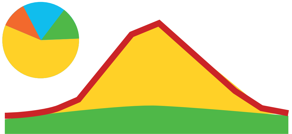
Figura 5. Variación de los consumos específicos residenciales de gas como función de los meses del año. Los datos ilustrados aquí son el promedio de los años 2010 al 2015 para la región centro-norte de Argentina. El diagrama de torta inserto en la parte superior izquierda, muestra cómo se distribuye el consumo de gas residencial entre sus distintos usos. Los consumos pasivos, se refieren al consumo de mantenimiento de termotanque y pilotos de calefones asociado a los sistemas de calentamiento de agua. El consumo de gas usado en calentar agua sanitaria (ACS) es la suma de calentamiento de agua propiamente y los consumos pasivos, es decir es del 34%.
