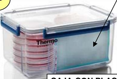
CAJA CON PLACAS PARA INCUBAR EN ANAEROBIOSIS
