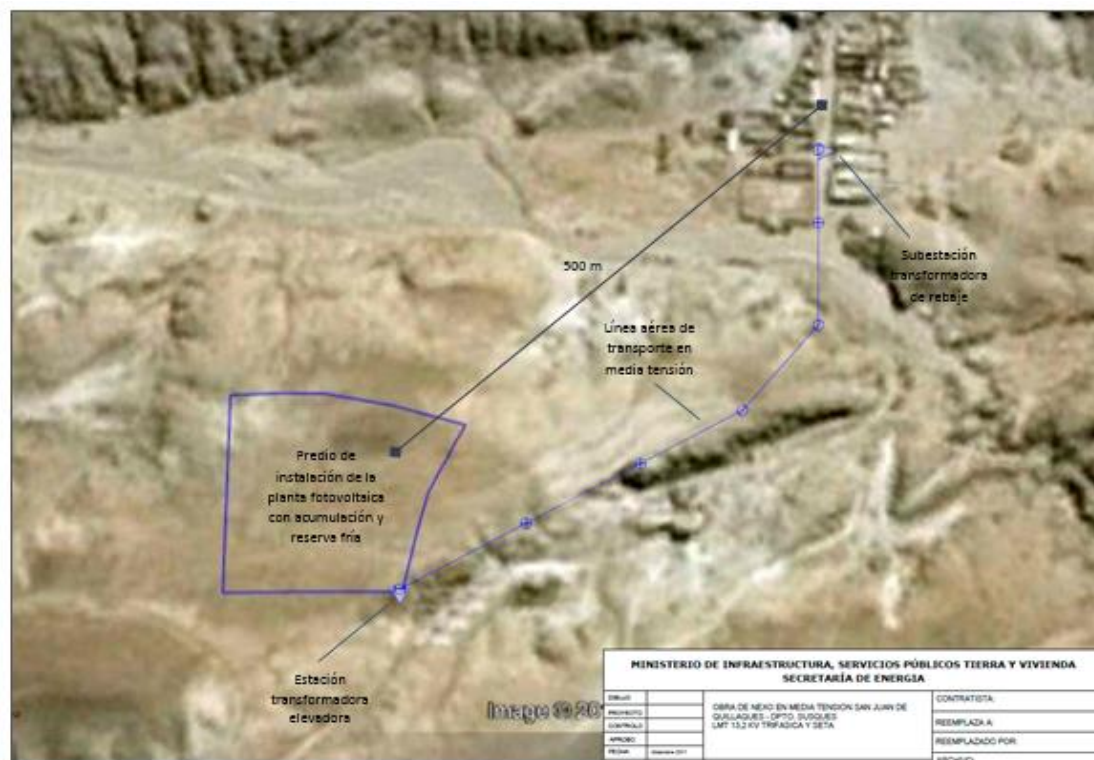
Mapa 2. Emplazamiento de la planta fotovoltaica con acumulación, la estación transformadora elevadora, el generador diésel con su infraestructura y subestaciones transformadoras.
