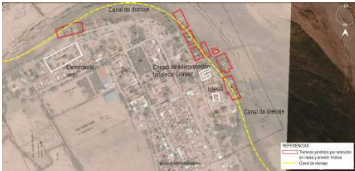
Fig. 6: Edificaciones colapsadas por ascenso de la freática. Superposición de un plano de 1979 (indicando las manzanas en el área urbana) con una imagen satelital actual. El ascenso de la napa y la erosión de ríos torrenciales en la margen del área urbana -colindante con el actual canal de drenaje-, han llevado a la pérdida de una gran porción de tierras edificadas, incluidas las manzanas delimitadas en rojo.
