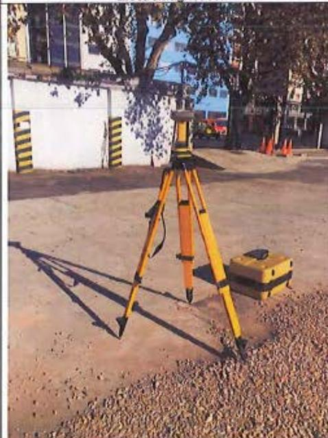
**Fotografía N°3: Equipo GPS topográfico.**
