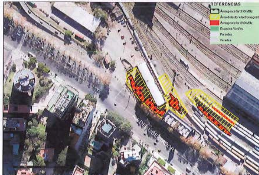
Mapa N°3: Área relevada con antena X3M de 500 MHz, 250MHz y con detección electromagnética en playa de estacionamiento y parrilla de vías del Museo Nacional Ferroviario.
