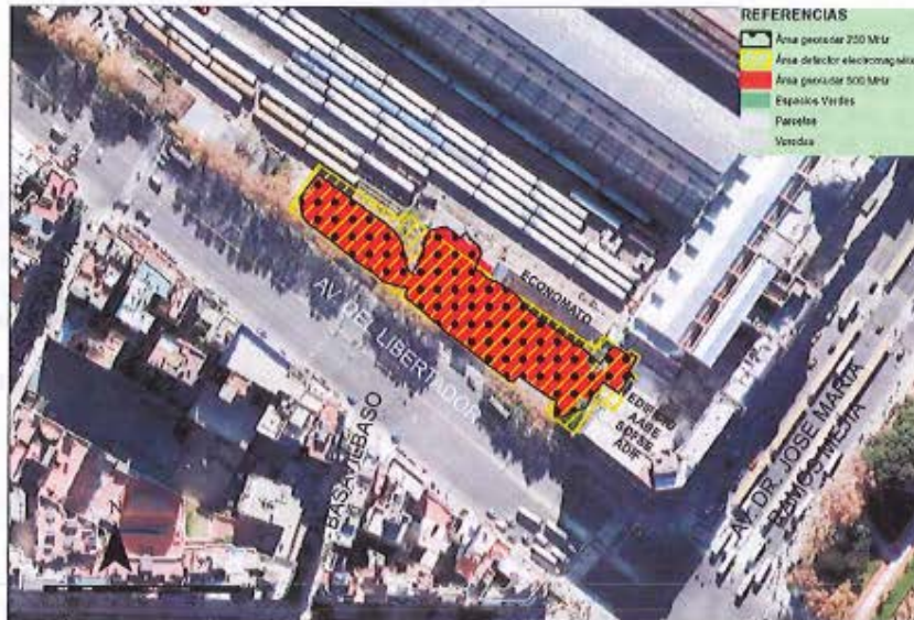
Mapa N°2: Área relevada con antena X3M de 500 MHz, 250MHz y con detección electromagnética en playa estacionamiento AABE.
