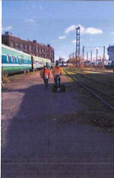
Fotografía N°5: Georadar en zona de vías.
