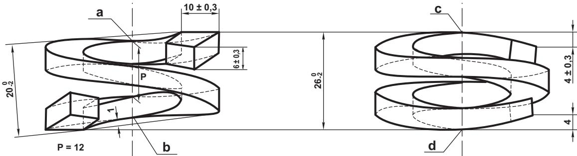
NOTA: EL ENROLLAMIENTO ES REGULAR SOBRE UNA ESPIRA PASO 12 mm ENTRE LOS PUNTOS a Y b. MAS ALLA DE LOS MISMOS LA HELICE ESTA DEFORMADA EN EL SENTIDO DEL AUMENTO DEL PASO HASTA c Y d EN DONDE LOS EXTREMOS ESTAN CURVADOS HACIA LA ESPIRA CENTRAL (PASO CONTRARIO).
