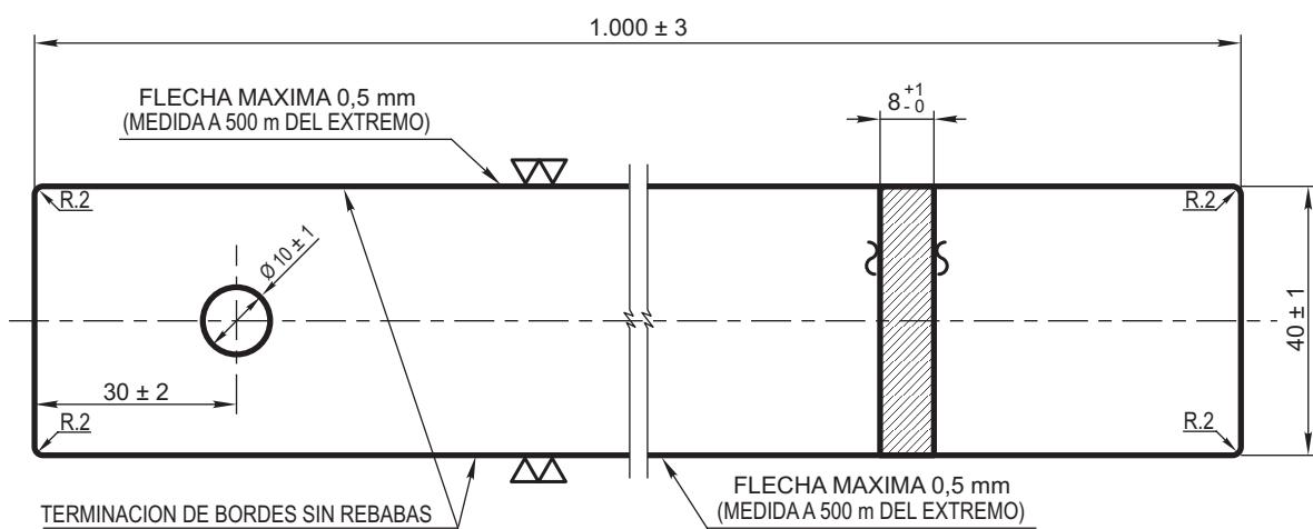
ACERO SAE 1045 - DUREZA BRINELL 250/260
