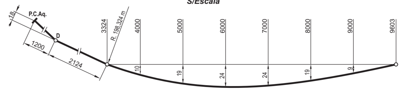
DIAGRAMA DE CURVADO DE LA CONTRAAGUJA FLECHAS SOBRE LA CUERDA EN BORDE DE RODAMIENTO S/Escala
