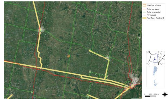
Gasoducto Regional Centro II desde Recreo por Ruta Nacional 19 y 34 hacia Rafaela.
