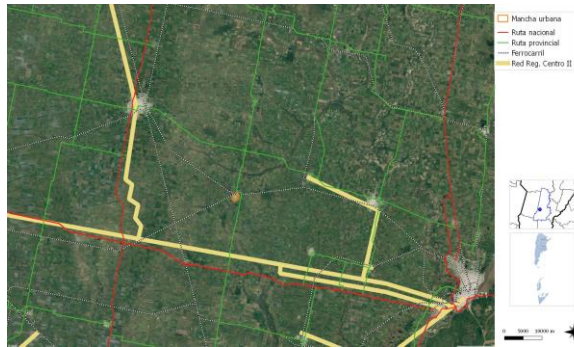
Gasoducto Regional Centro II desde Recreo por Ruta Nacional 19 y 34 hacia Rafaela.
