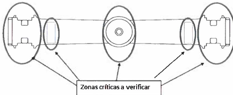
Deberá realizarse ensayos de tintas penetrantes o partículas magnetizables a las zonas críticas o susceptibles de desgaste, tanto sea en la estructura como en las soldaduras dejando registro de los resultados obtenidos.-
