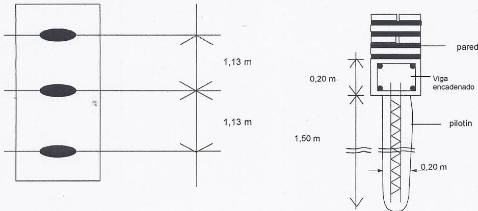
Para el cálculo considero la acción combinada de la viga de encadenado y en pilotin, implica resistencia plena.
