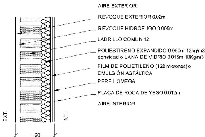
MURO DE LADRILLO COMÚN DE 12 + AISLACION (6 CAPAS) / K=0.57 W/m<sup>2</sup>K
