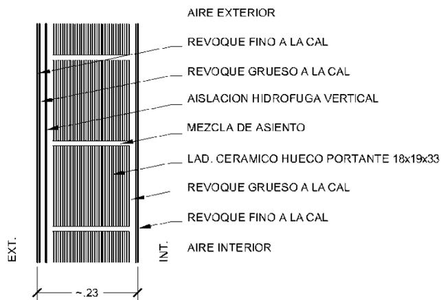
MURO DE LADRILLO CERAMICO PORTANTE DE 18x19x33
