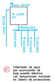
Ⓣ Calentador de agua por acumulación de baja presión eléctrico con temporizador instalado en tablero de protecciones
