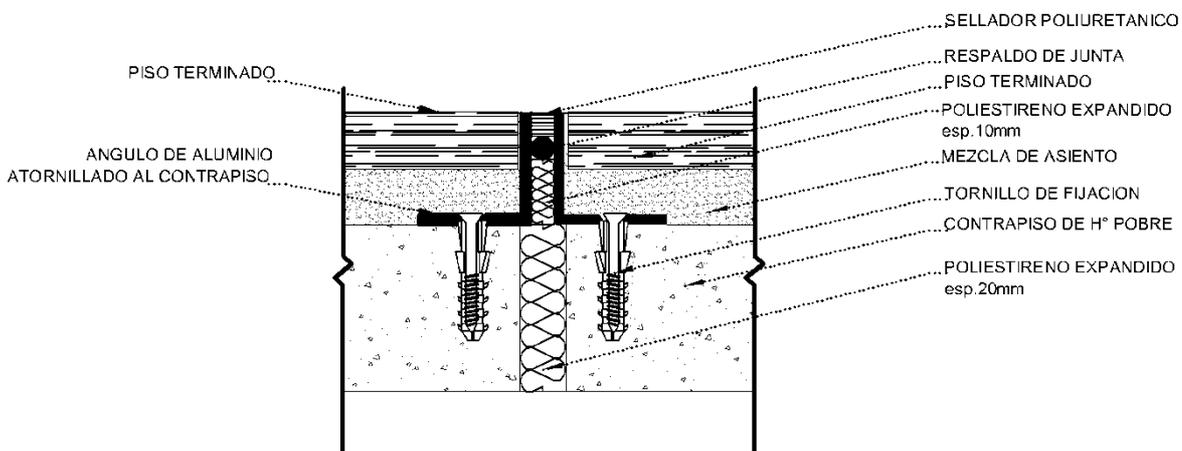
DETALLE JUNTA PISO GRANITICO (en coincidencia con junta estructural)
