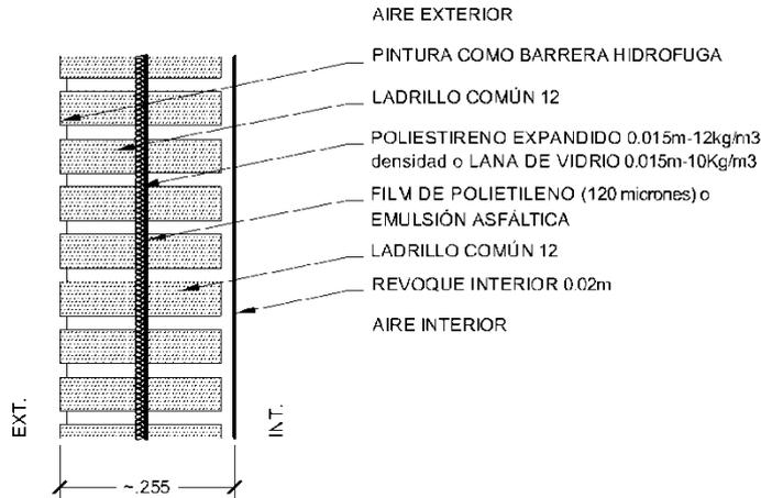
MURO DOBLE LADRILLO COMÚN DE 12 + AISLACION (6 CAPAS) / K=1.13 W/m<sup>2</sup>K
