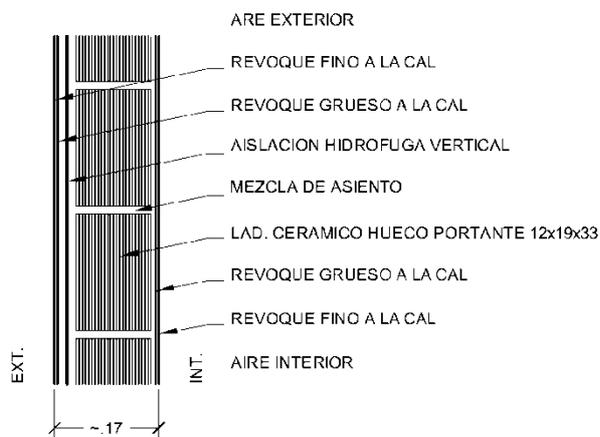
MURO DE LADRILLO CERAMICO PORTANTE DE 12x19x33
