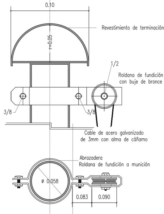
DETALLE ROLDANA CON ABRAZADERA ESC 1:2
