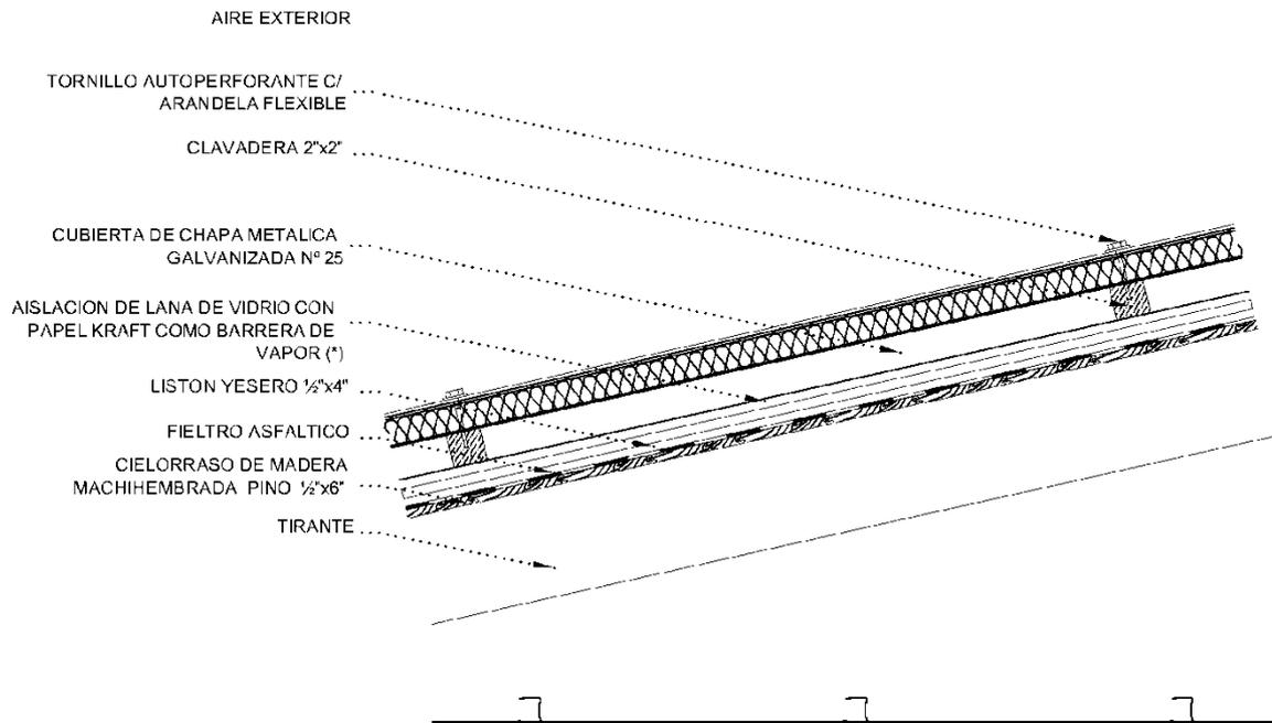
CON ESTRUCTURA DE MADERA OCULTA - (\*) EPS 20Kg/m3 esp.70mm/ K=0,60W/m²K
