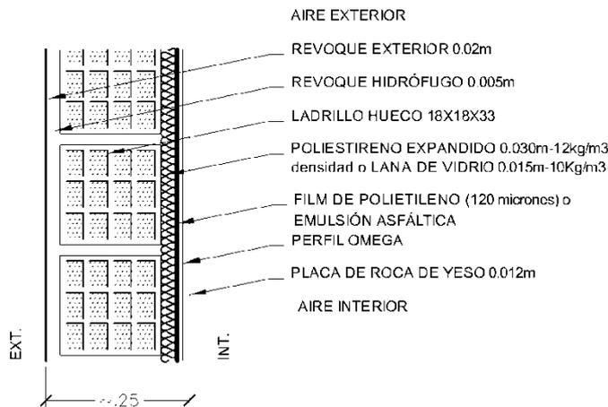
MURO DE LADRILLO HUECO DE 18 + AISLACION (6 CAPAS) / K=0.60 W/m<sup>2</sup>K
