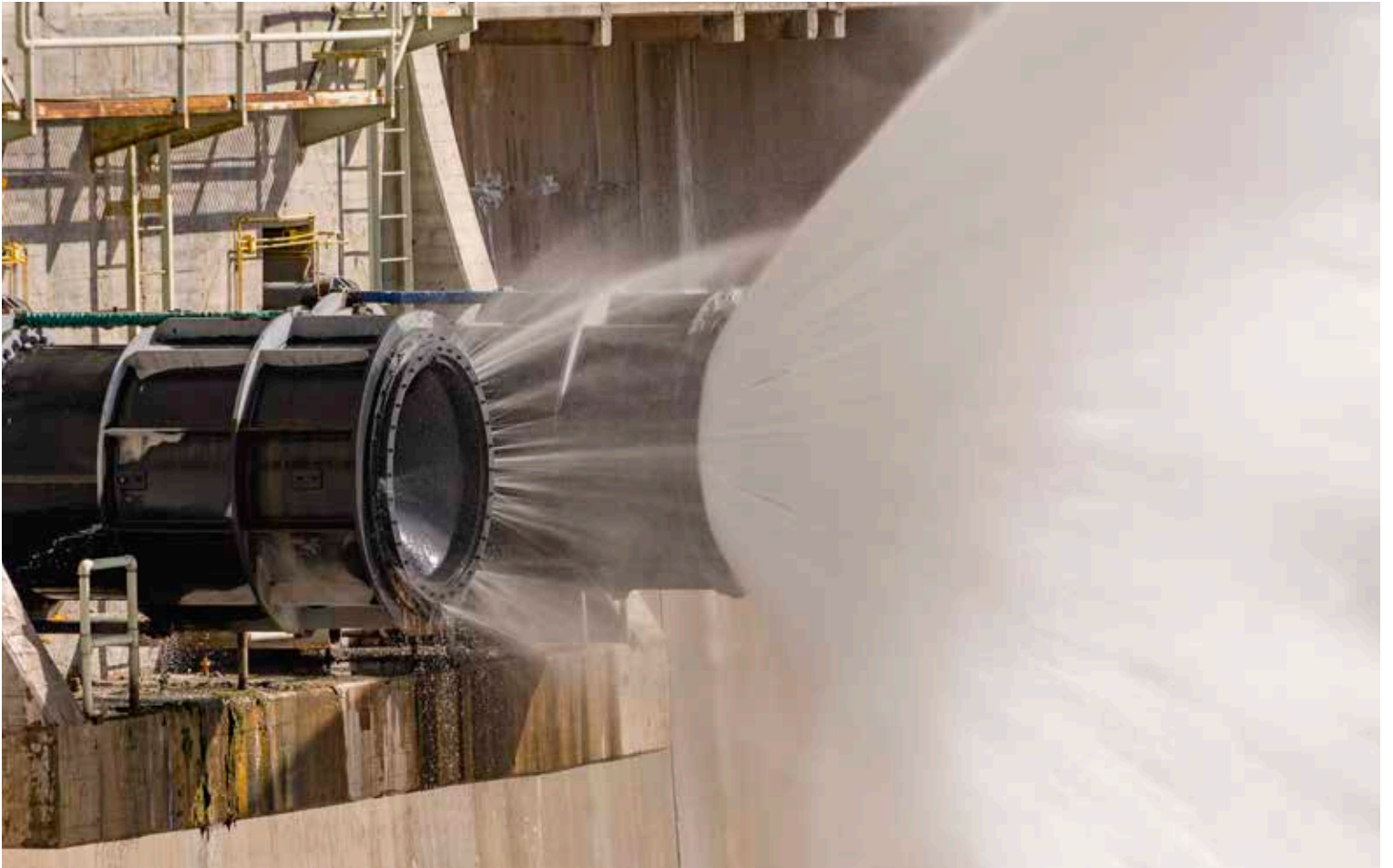
Prueba de funcionamiento de las válvulas de riego, Agua del Toro, Mendoza.
