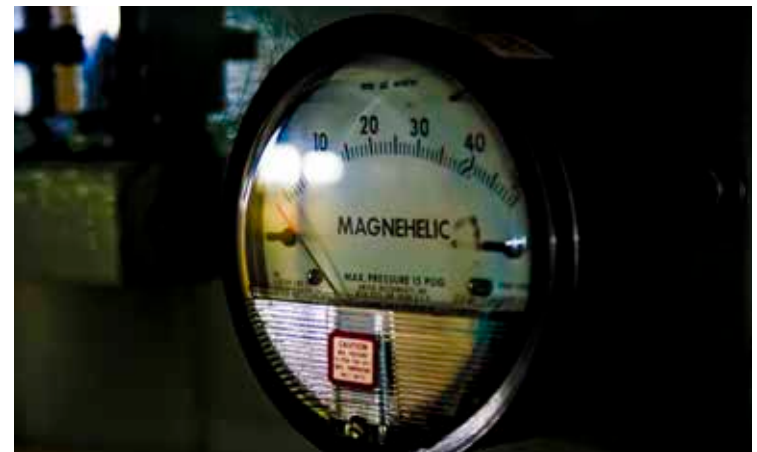
Manómetro para presiones diferenciales, Piedra del Águila.
