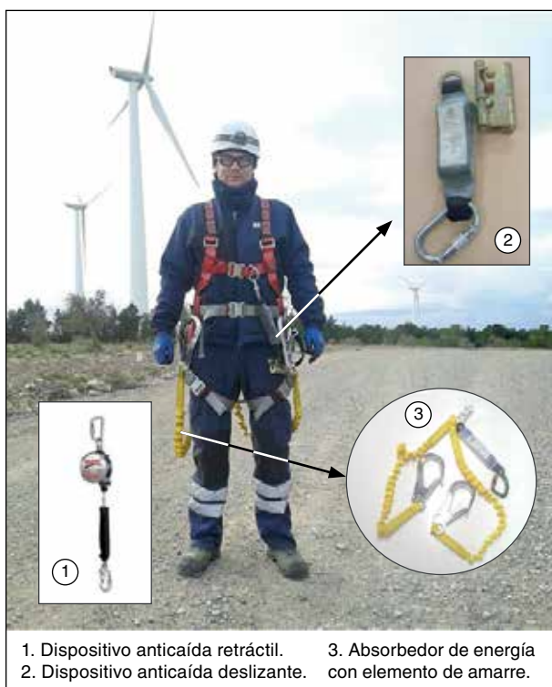
Figura 1. Operario equipado con arnés, absorbedor de energía con doble elemento de amarre, dispositivo anticaída deslizante para línea de anclaje rígida, casco de seguridad, botas de seguridad, linterna frontal para zonas de baja iluminación.
