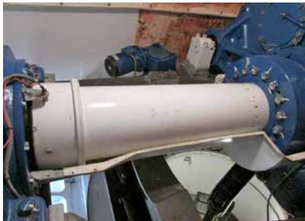
Figura 5. Eje lento sin resguardo.
