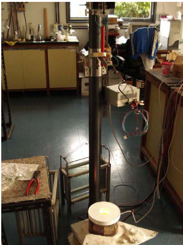
Torre de estiramiento para el conformado de fibras de vidrio.
