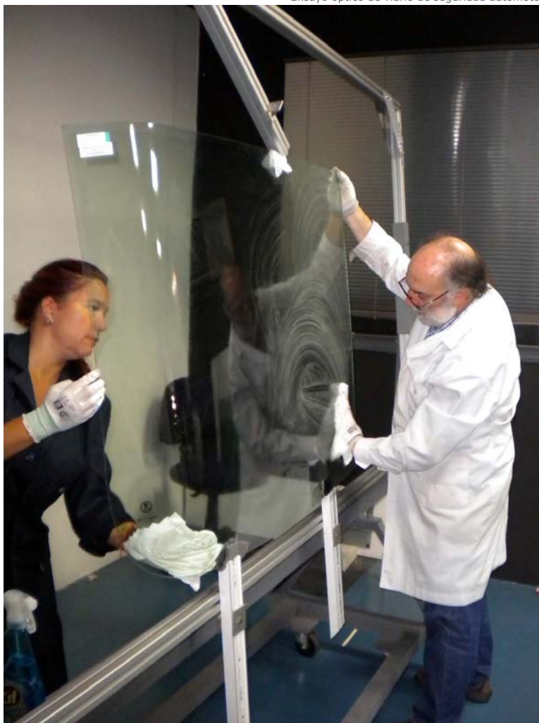
Ensayo óptico de vidrio de seguridad automotor
