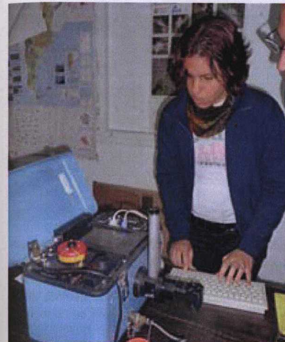
Mediciones con el espectrómetro FTIR (rango termal)
