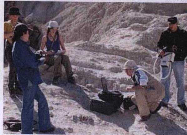
Mediciones con radiómetro SVC en las tobas de El Alcázar
