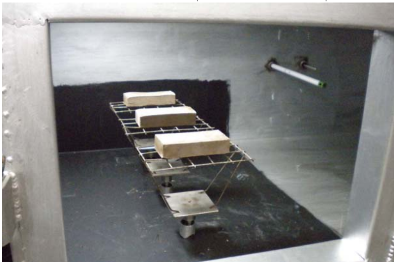
Balanzas indicadoras del constante cambio de peso de cada muestra durante el proceso de secado.
