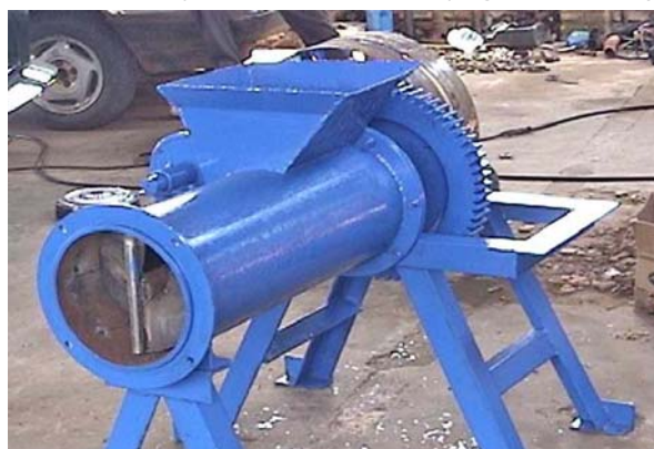
Extrusora para conformado de distintas tipologías de cerámica roja
