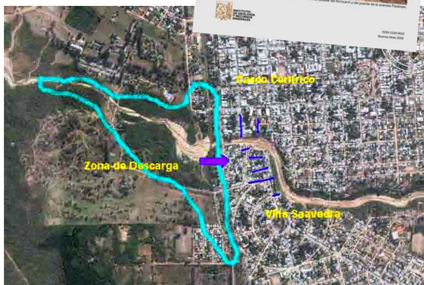
Vista con indicación aproximada de la zona embalsada, el sector de descarga central y las líneas de escurrimiento principales, donde se dan los procesos erosivos retrogradantes en la ciudad de Tartagal.
