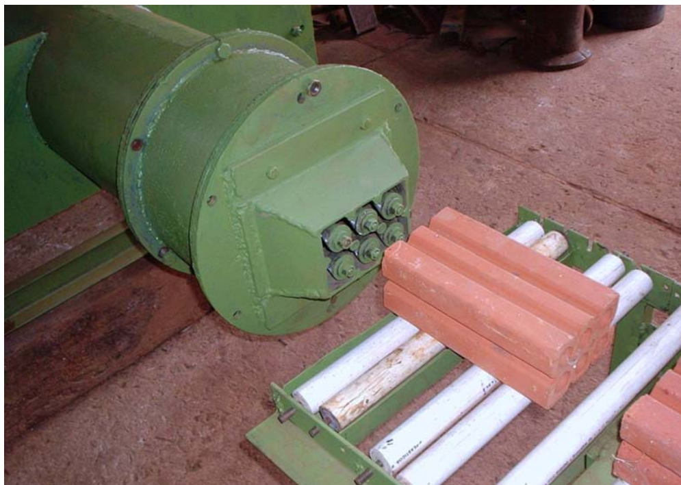
Molde para ladrillo hueco
