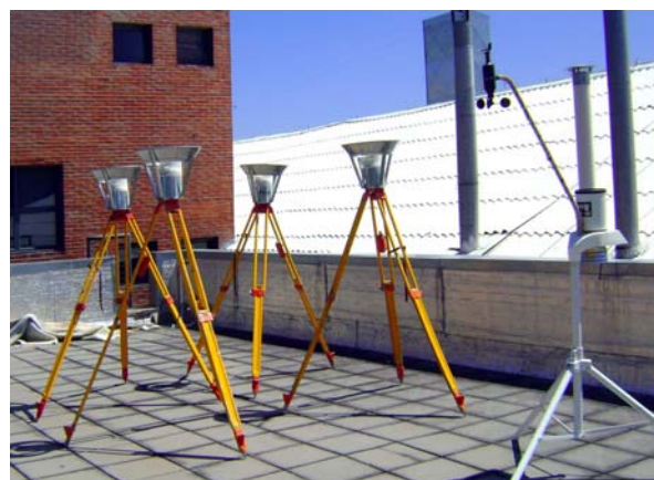
Equipos Desarrollados en el Area de Calidad para Determinar la concentración del polvo atmosférico Sedimentable ASTM D 1739
