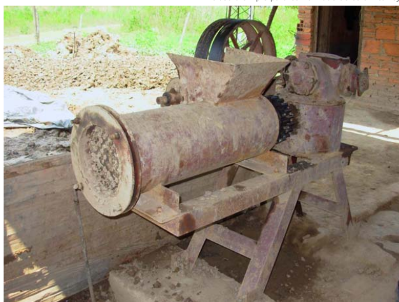
Extrusora simple para conformado de cerámica roja
