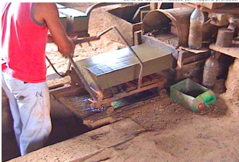
Corte de ladrillos macizos con máquina prensadora
