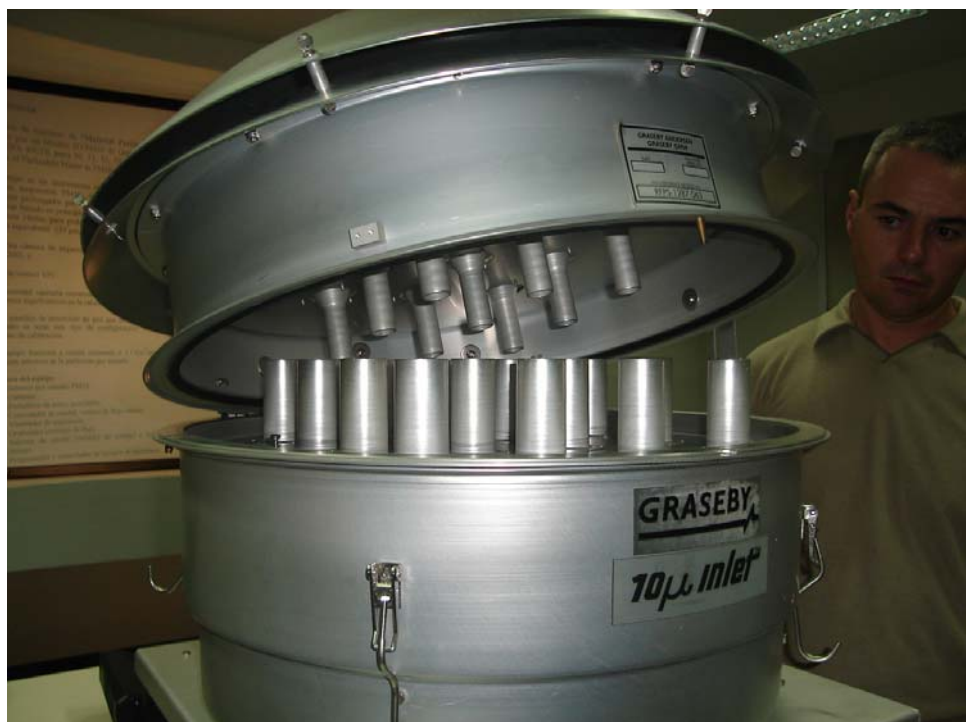
Cabezal separador de partículas menores de 10 micrones.
