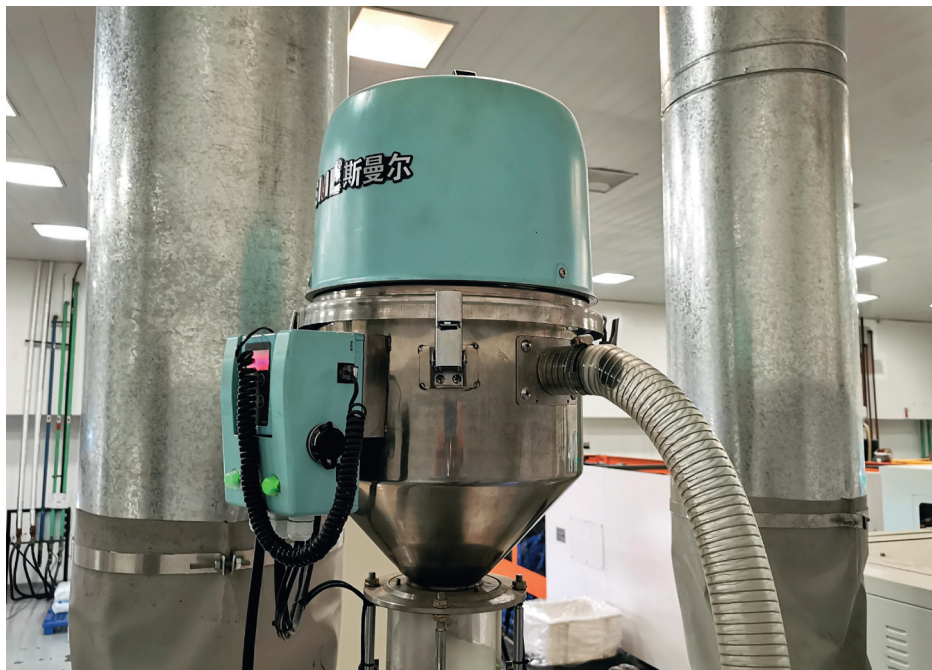
Alimentador automático de pellets por succión.
