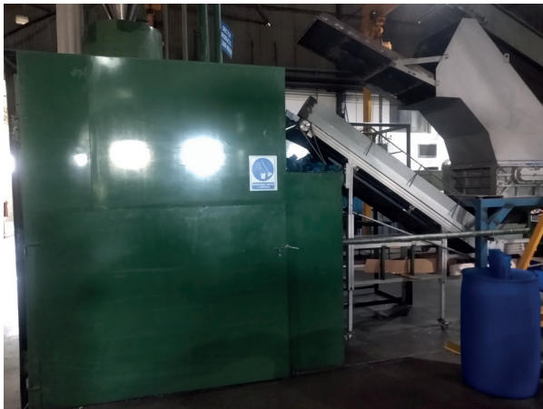
Trituradora encapsulada para disminuir el ruido.
