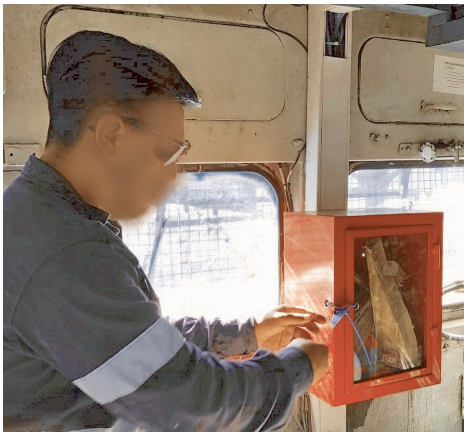
Verificación de precintos de elementos de seguridad.
