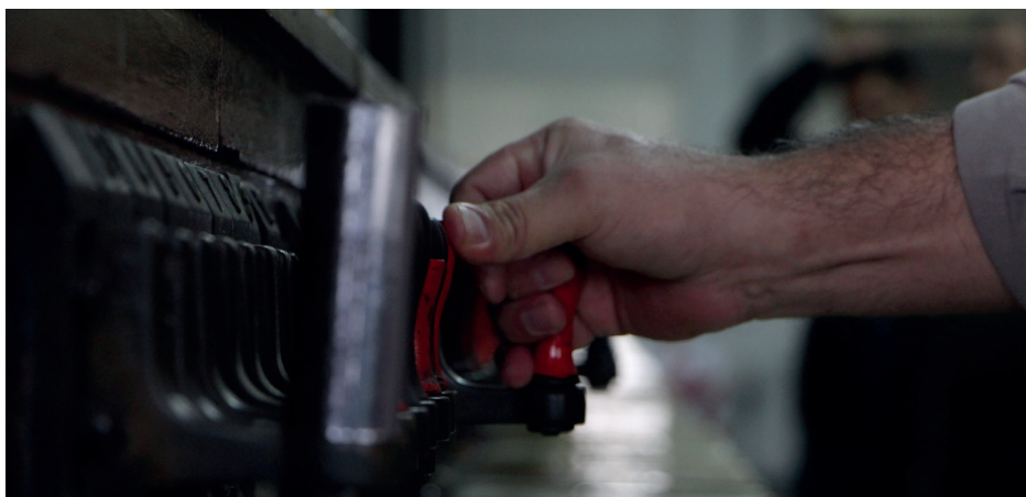
Accionamiento de palanca electroneumática.
