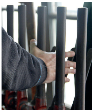
Cabina mecánica (posición corporal correcta para el accionamiento manual de palancas).
