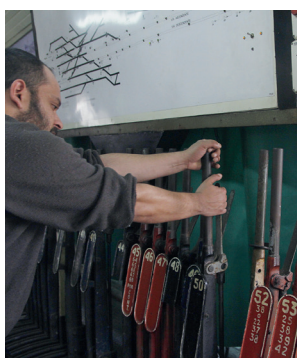
Cabina mecánica (posición corporal correcta para el accionamiento manual de palancas).
