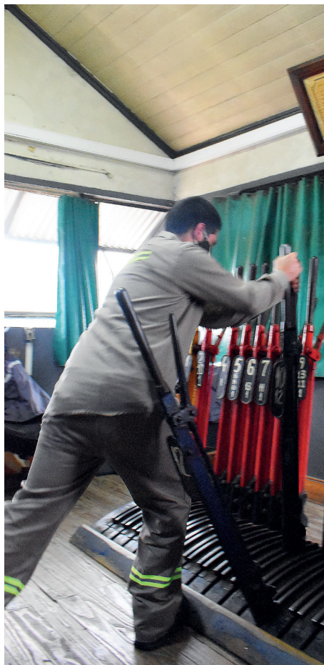
Accionamiento manual de palancas en una cabina mecánica.
