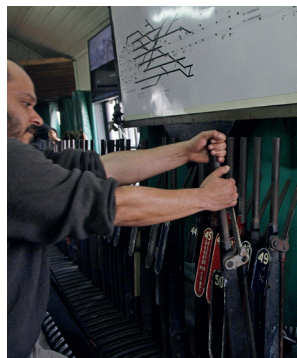
Cabina mecánica (posición corporal correcta para el accionamiento manual de palancas).
