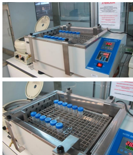
Figura 1. Baño termostático agitado mostrando los tubos tipo Falcon con los cultivos de levaduras.
