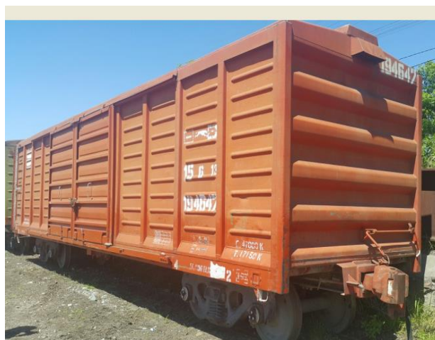
Vagón Cubiertos (Con Reforma Todo Puerta) CT-15 Trocha 1000.”
