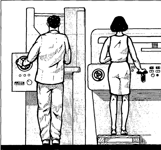
Figura 58a. Utilice plataformas bajo los pies para los trabajadores más bajos con el objeto de asegurar una altura de trabajo apropiada, en torno al nivel de los codos
