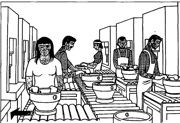
Figura 6b. Una línea transportadora pasiva para mover piezas pesadas de motores a la altura de trabajo
