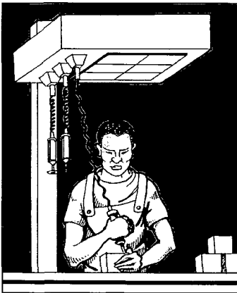
Figura 24c. Proporcione una estructura especial, por encima del trabajador, en la que puedan suspenderse las herramientas por medio de mecanismos de resorte
