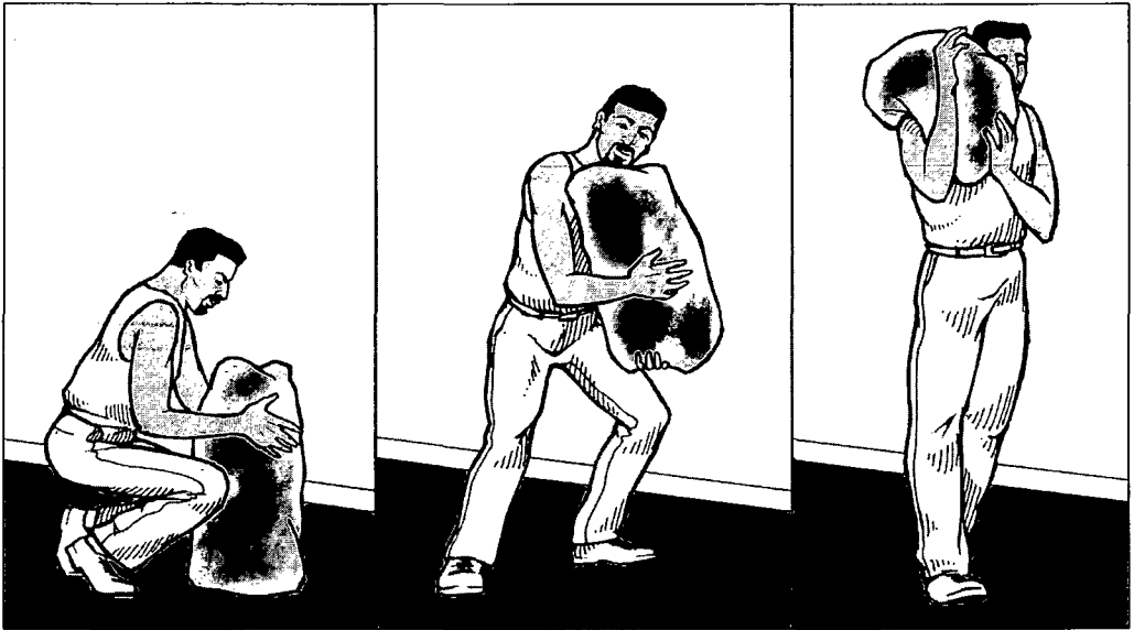
Figura 16a. Realice el levantamiento o depósito de una carga pesada por delante del cuerpo, manteniendo la espalda derecha y con los pies en una posición estable, y empleando la fuerza de las piernas
