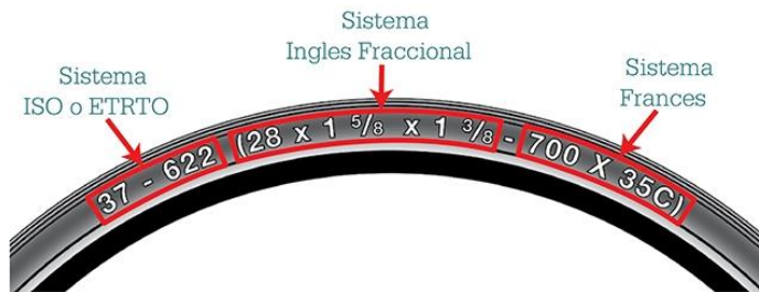
Figura IV.1. Identificación de los sistemas de medidas en los neumáticos para bicicletas
