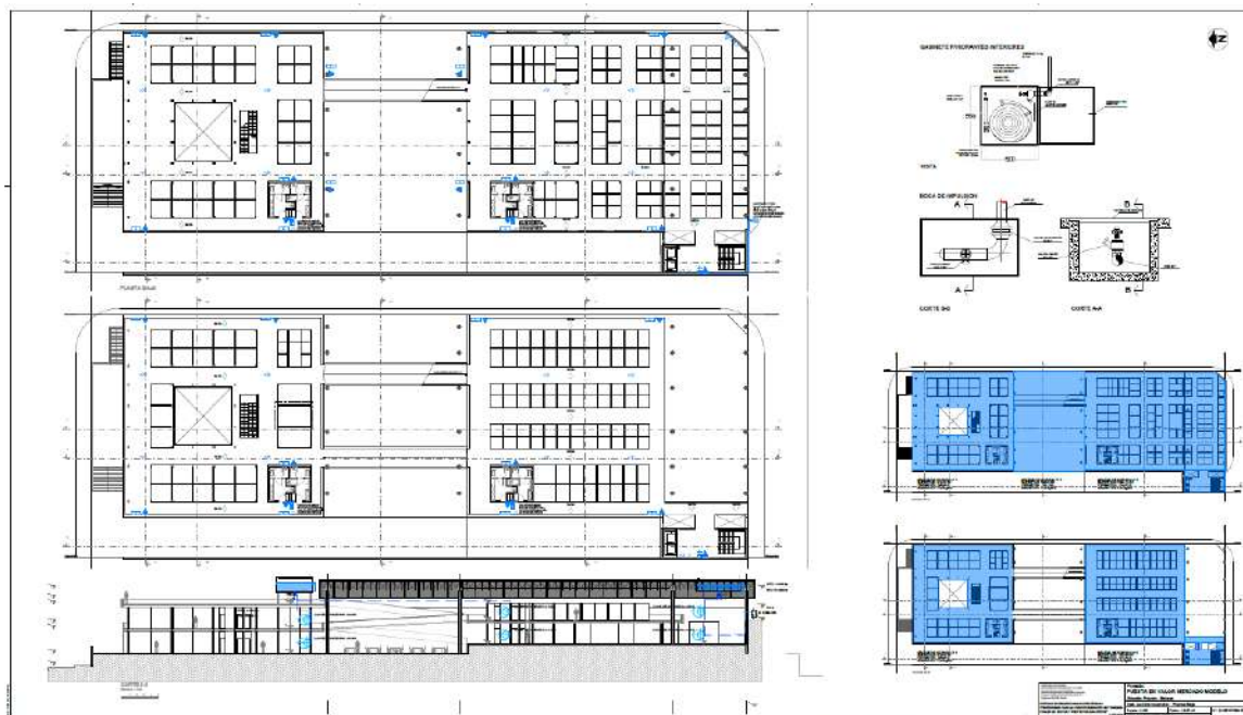
21- Planta B, A + Detalle tanque de reserva, 1:100. Hidrantes, matafuegos, carteles salida de emergencia. Capacidad reserva total diaria y reserva contra incendio, niveles. T.R. conexión desde red, II.p, flotante, bajada a colector Ø, bajadas para AF y AC.
