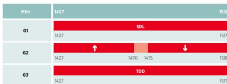
Ilustración 13. Opciones de disposición de frecuencias en la banda de 1427 - 1518 MHz.
