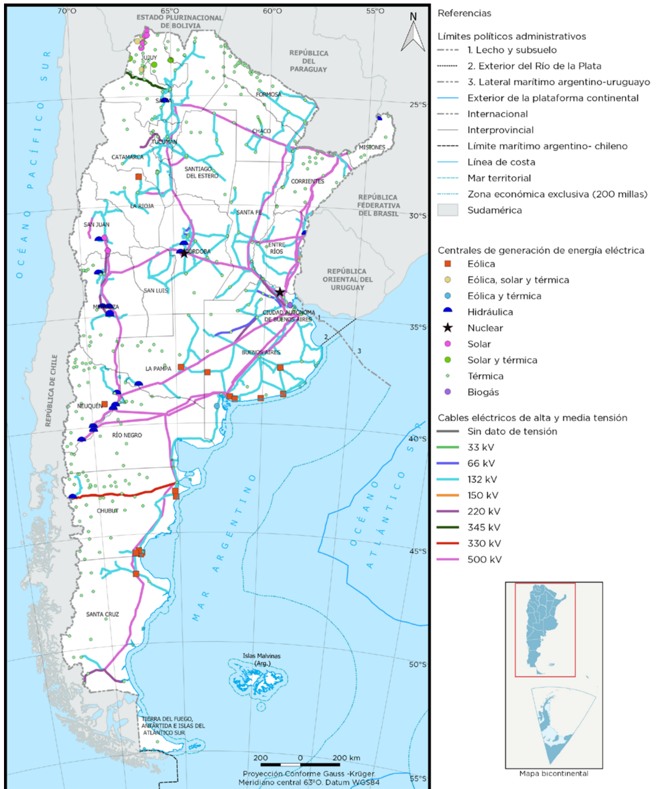
Figura 4. Localización de los principales centros de producción (según tipo de fuente) y red de distribución de energía de alta y media tensión en Argentina, 2019.
