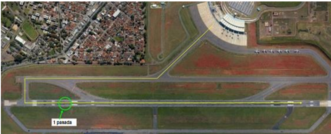
Figura 35: Número de pasadas sobre el pavimento en aeródromos con calles de rodaje con acceso a los umbrales.
