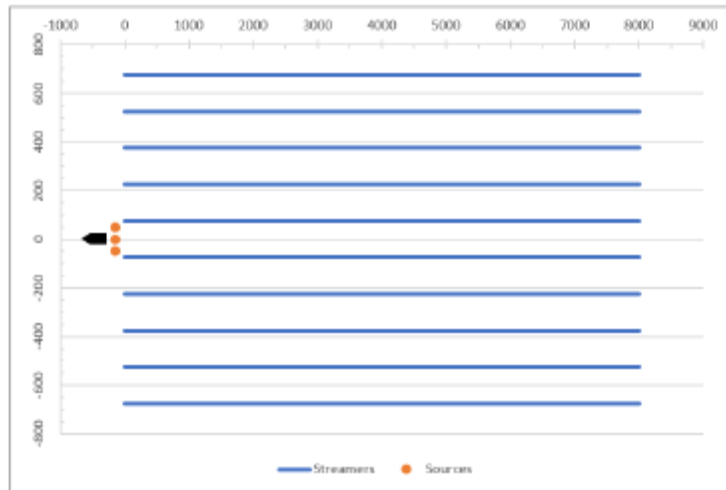
Figura 7. Esquema de disposición de las fuentes de energía de aire comprimido (sources) y streamers. Fuente: EQUINOR
