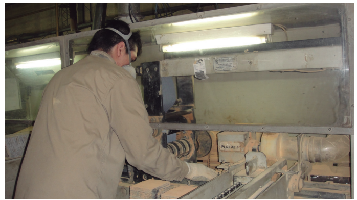
Proceso de estacionamiento de placas de plomo.
