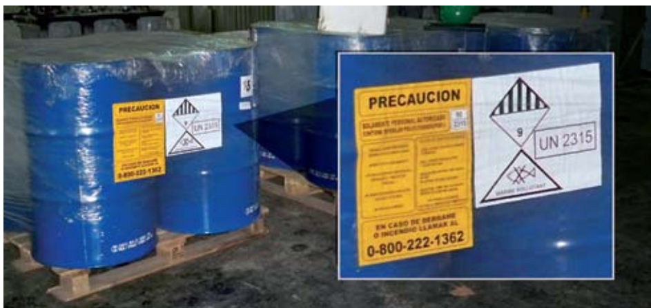
Embalaje de residuos peligrosos de aceites conteniendo concentraciones elevadas de BPC (CSC Y10) para su exportación. Los tambores son aprobados por la Prefectura Naval Argentina (PNA); el etiquetado responde a los requisitos de la Organización Marítima Internacional (OMI); foto gentileza DRP - SayDS
