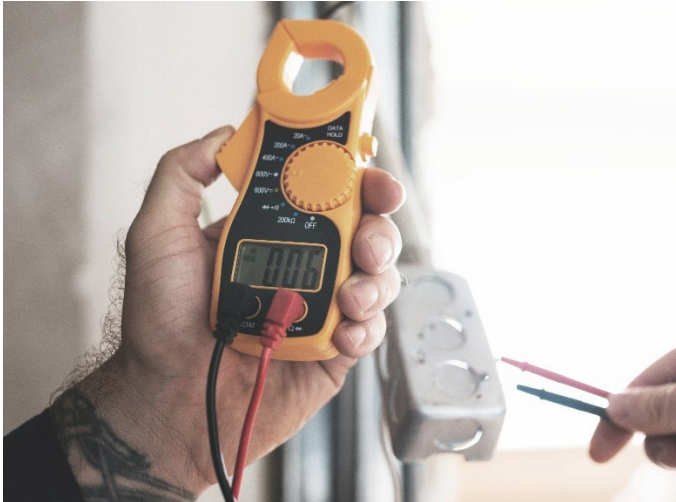
Figura 4.4. En casos más complejos se pueden medir consumos en tableros. Corrientes altas o inesperadas pueden dar idea de que hay algo encendido que no debería estar. Imagen: freepik.com
