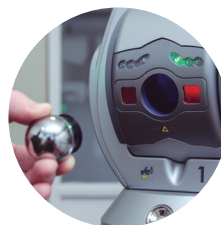
Láser tracker, para calibrar máquinas de medir y herramientas
