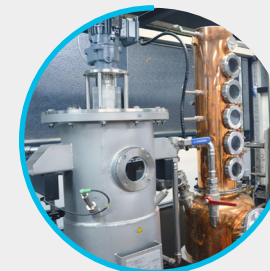
Planta piloto compacta para la generación de Bioetanol
