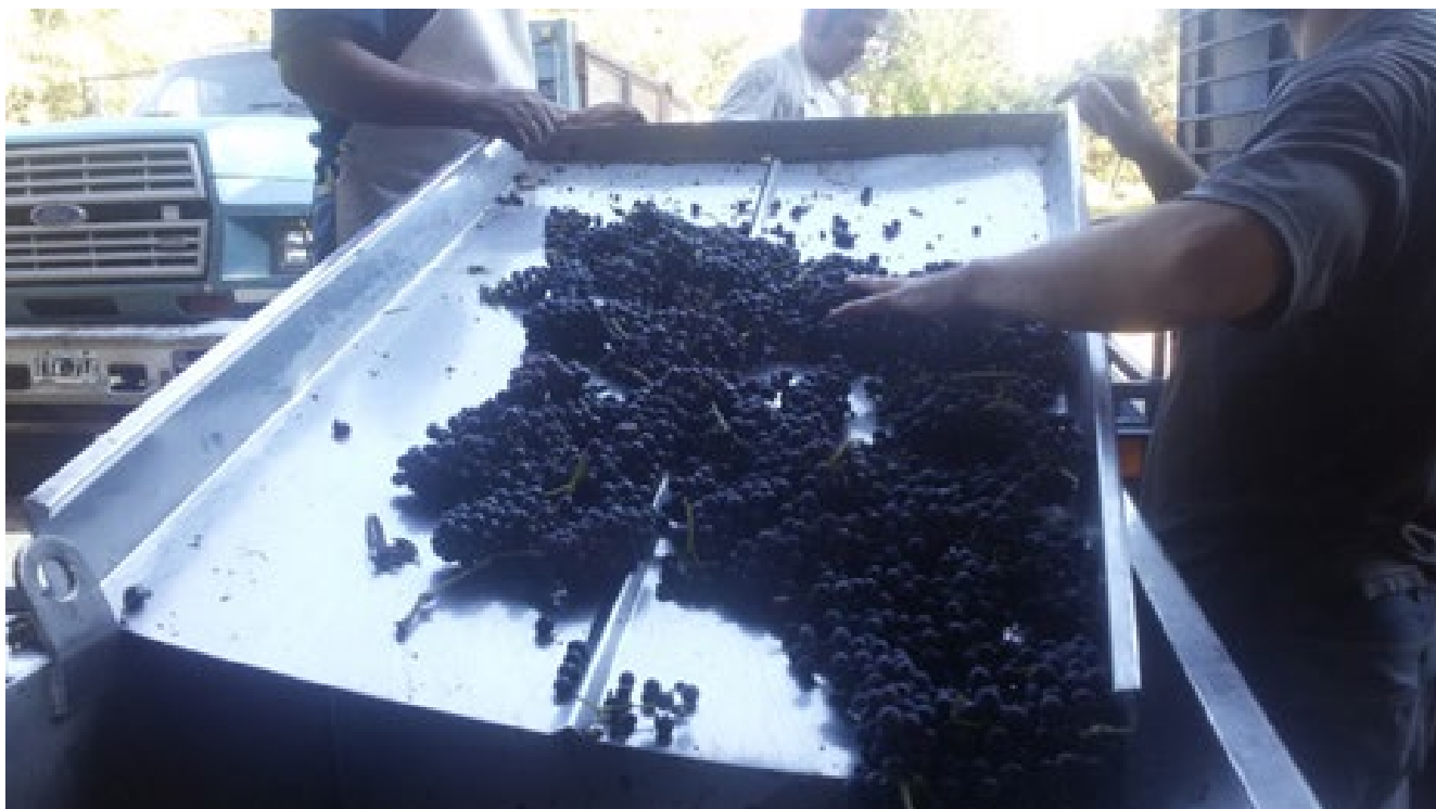
Foto 2. Tolva con rampa de selección (Foto: Ing. Nazrala FCA-UNCUYO). En esta tolva se hace el ingreso de la uva a la bodega, de esta forma se puede hacer una selección de racimos en mal estado, u hojas que vienen de la cosecha en la finca.
