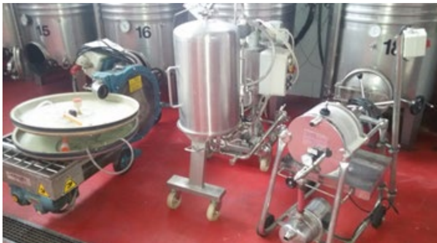
Foto 4. Filtros sala de fermentación (Foto: Ing. Nazrala FCA-UNCUYO). El filtrado es un proceso luego que ha finalizado la fermentación y el vino se ha estabilizado. Se utilizan filtros en la sala de fermentación para separar el vino de impurezas y poder pasarlo a la sala de embotellado.
