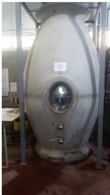
Foto 3. Tanque de fermentación de cemento (huevo). (Foto: Ing. Nazrala FCA-UNCUYO). Es un tanque de cemento donde se hace la fermentación (proceso natural por el cual se forma el vino, gracias a las levaduras).
