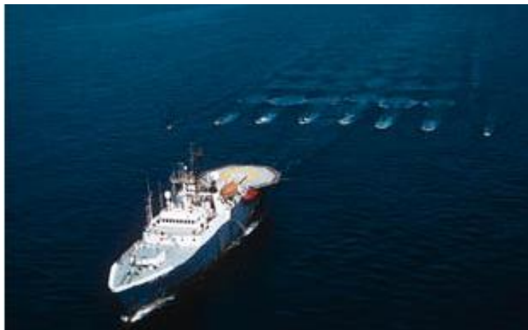
Figura 2. Fotografía de un buque sísmico, las fuentes de emisión, el cable sísmico ( streamers ) y la boya de cola.
