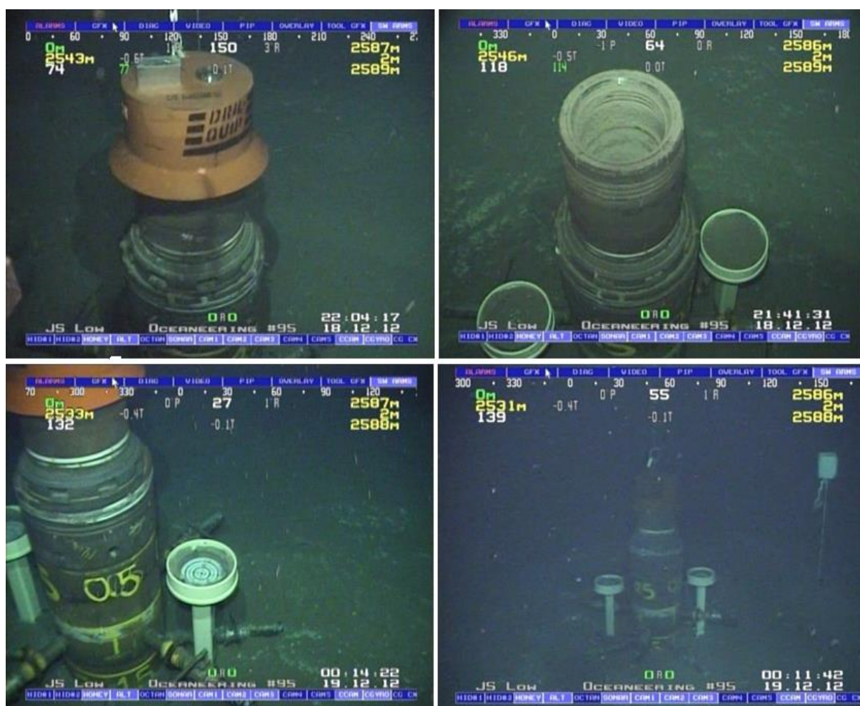
Figura 4-19: Ejemplo de cabeza de pozo en posición
