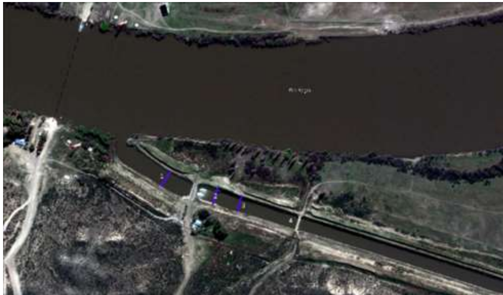
Figura 7. Opciones de puntos a instalar para la medición del nivel del agua
