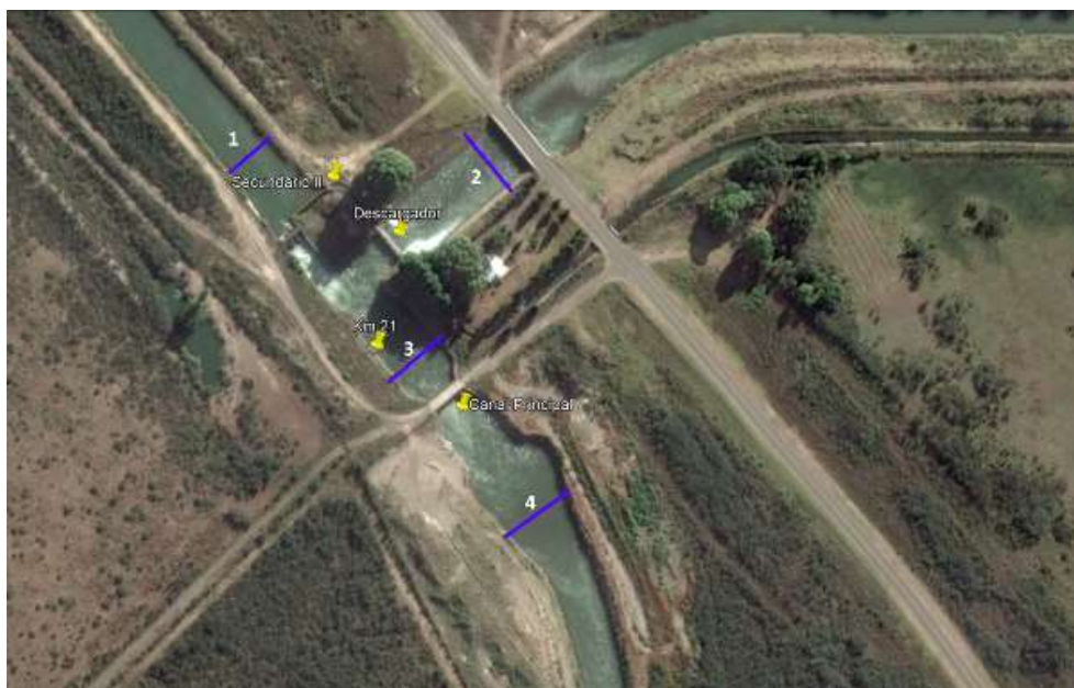
Figura 8. Referencia de registro para instalación Sensor de Altura / Caudal Radar
