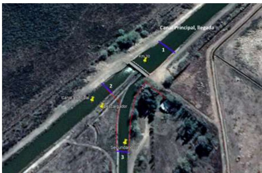
Figura 9. Referencia de registro para instalación Sensor de Altura / Caudal Radar
