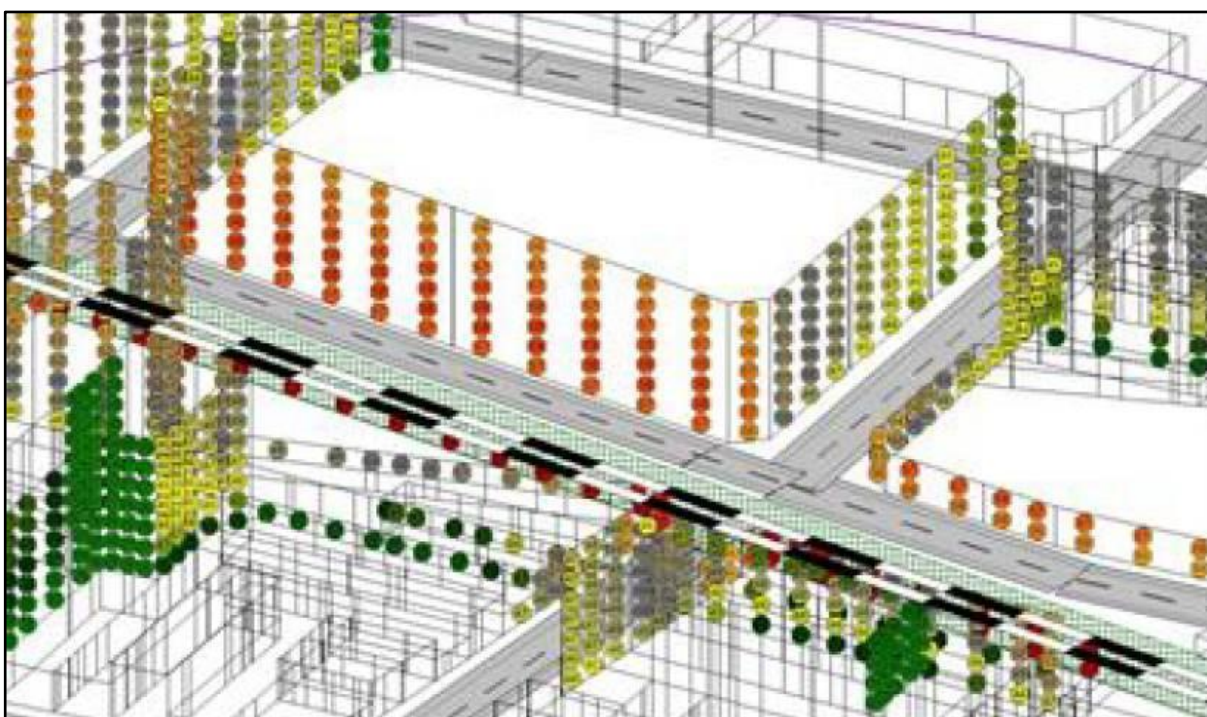
Figura 4.2. Modelado de ruido sobre receptores residenciales. Tren eléctrico.
