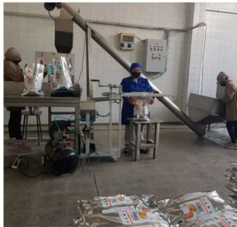
Línea semi automática con sellado manual destinada a comidas preelaboradas fortificadas
