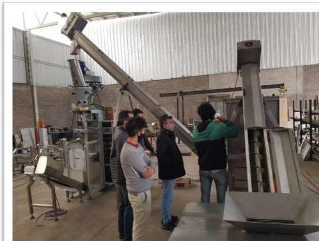
Mezcladora y envasadora automática marca King Kong con cabezal dosificador a tornillo sinfín destinada a comidas preelaboradas sin fortificar
