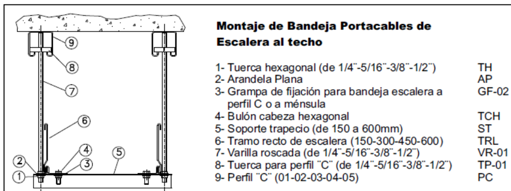
Imagen 6. Montaje de bandeja.
