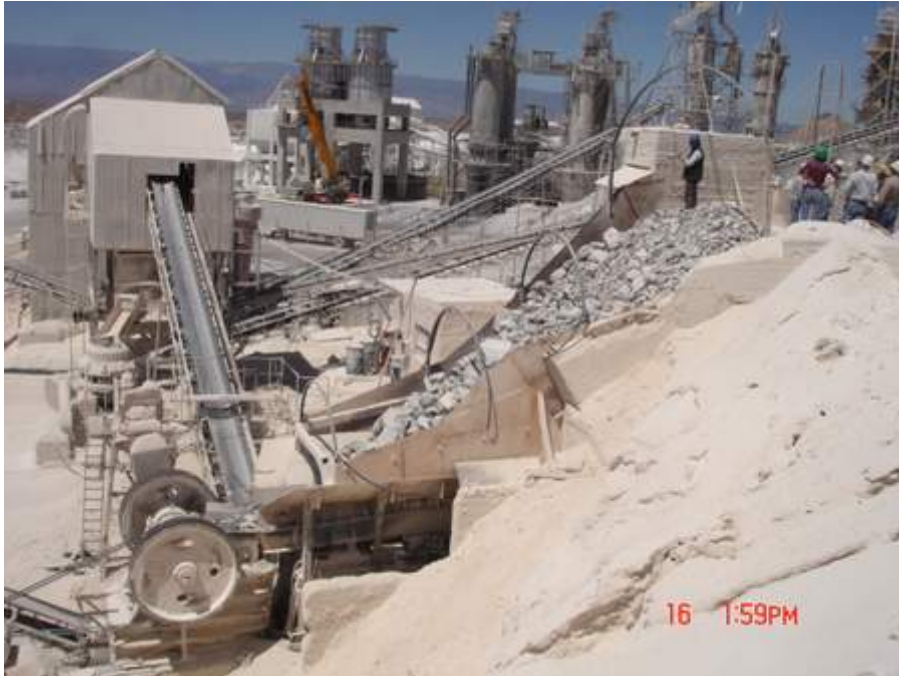
Salida del material triturado por cinta transportadora
