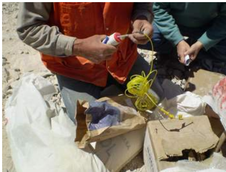
Preparación del Booster con el cordón detonante
