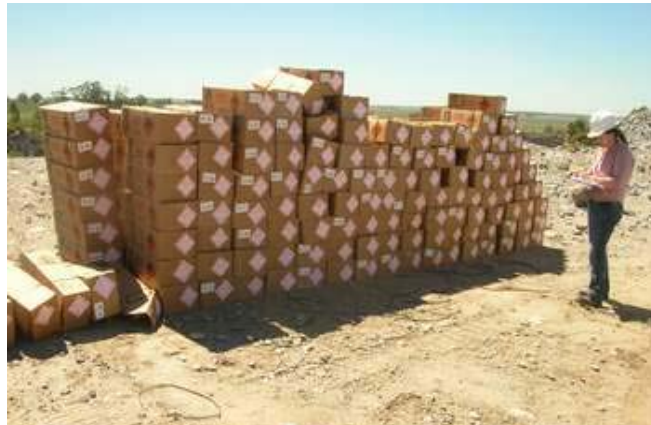
Inadecuado almacenamiento de explosivos
