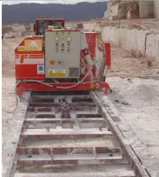
Distintas vistas de máquina con espada de corte
