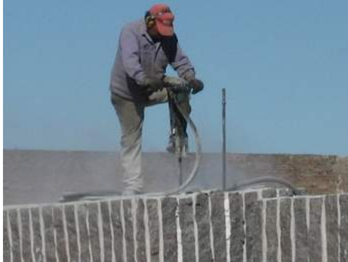
Perforaciones para realizar el corte
