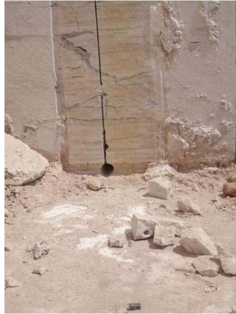
Vista de perforaciones vertical y horizontal
