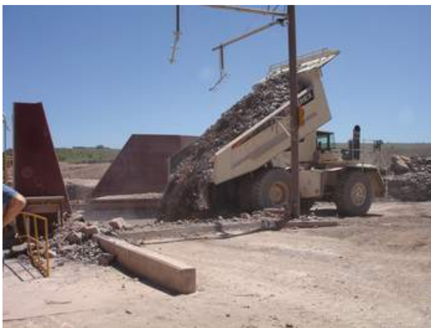
Descarga de rocas en trituradora
