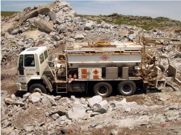
Camión de transporte de explosivos con dosificador
