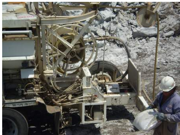
Camión de transporte de explosivos con dosificador
