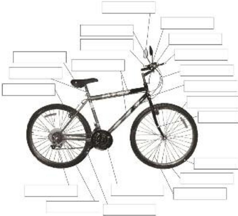
Asiento – Tubo de asiento – Frenos traseros – Vaina (superior e inferior) – Piñones – Cambio trasero – Cadena – Cambio frontal – Platos o estrellas – Pedal – Cuadro (tubo superior y tubo inferior) – Válvula – Cubierta – Llanta – Rayos – Tijera – Frenos delanteros – Horquilla – Manubrio – Puño – Espejos retrovisores
